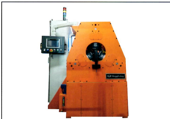
使用機: レッグローリング製 3 ダイス転造機 3R40HD (有)三嶋商事 転造開発センター所有
