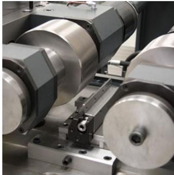
削って加工する「切削」に対し、塑性変形により加工するのが『転造』という技術です。仕上がり形状を持った工具を素材に押し付けて成形することによって加工して行きます。
